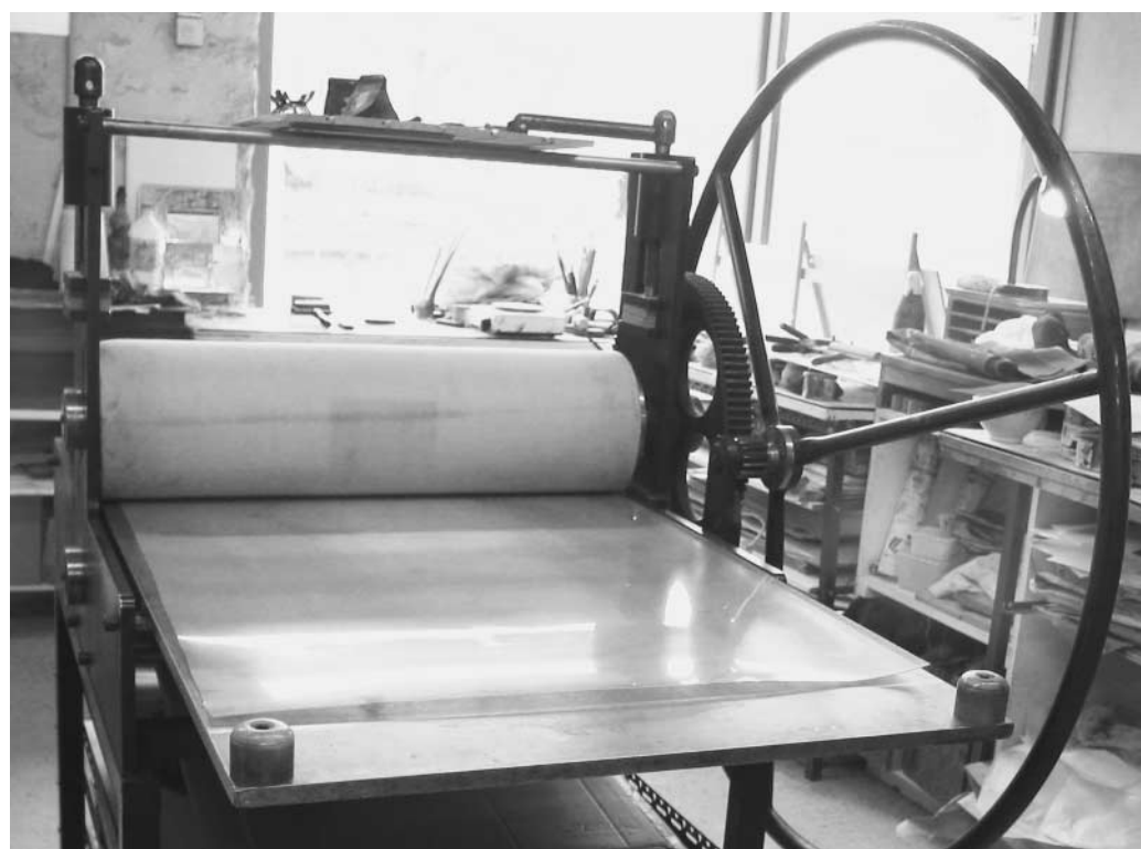
Presse taille-douce, avec son plateau, son cylindre supérieur langé et sa roue.
