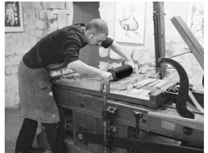
Encrage de la pierre au rouleau.
