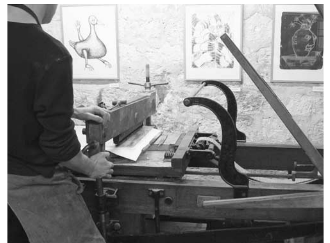
Mise en place du râteau et essais de pression.
